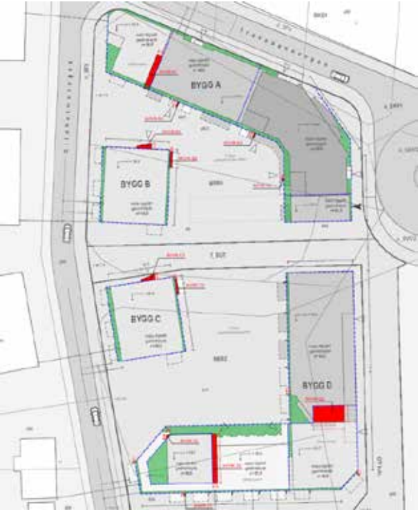
Oversikt over avvik i rødt og unnlatt bygd areal i grønt.
